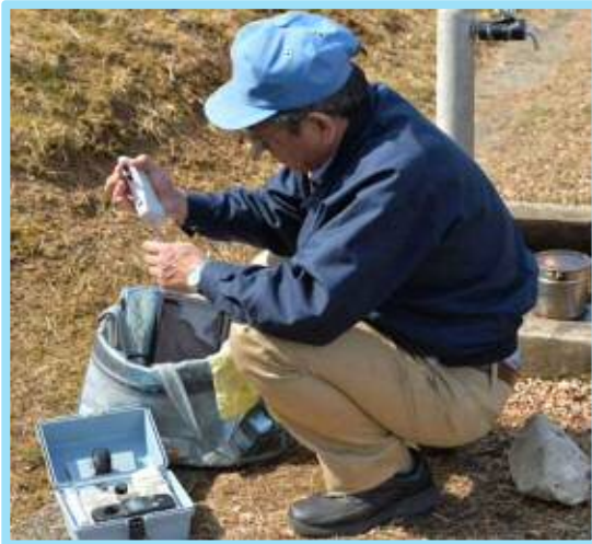
写真 3-1 : 市内の公園の蛇口の水を採取して 塩素消毒が行き届いていることを検査している風景
