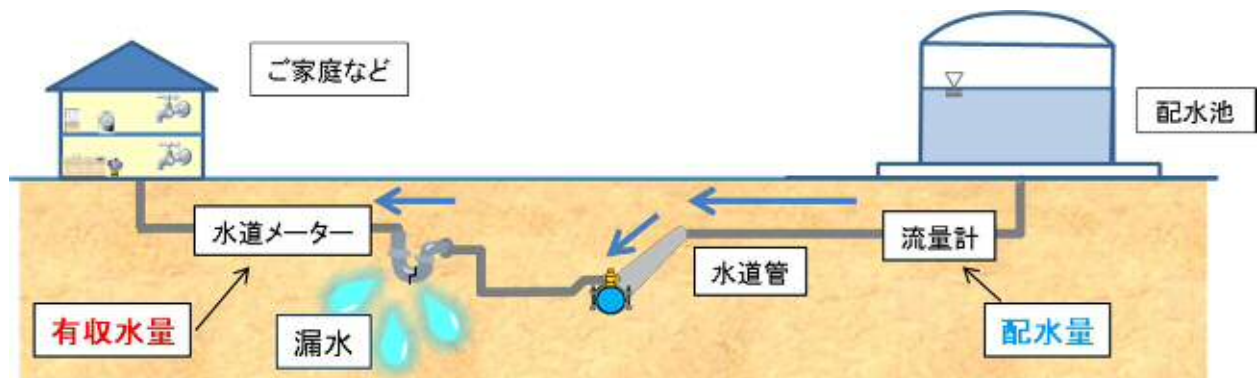
図 3-12 管路の漏水イメージ
